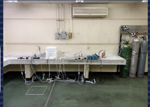
バイオガス利用H<sub>2</sub>製造反応実験装置
